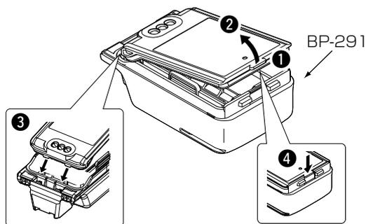
2. ①の部分で指で押しながら、②の方向に引き上げて取り出します。
