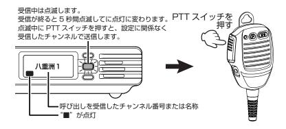
[P1] キーの点滅が点灯に変わると再びマルチチャンネル待ち受け動作を開始します。
