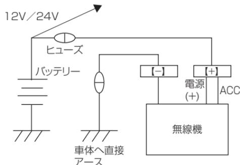
本装置は、12V/24V車両専用に設計されています\*。
